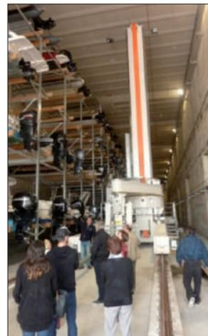
L'équipe des ports de plaisance de la *Sellor* a permis au public de découvrir le fonctionnement du port à sec de la base des sous-marins. Installé dans deux alvéoles du bloc K2, il peut stocker 280 bateaux à moteur grâce à deux automates, pièces maîtresses de ce système innovant.
